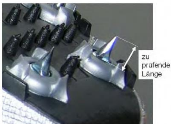
Spikes-Prüfung auf Länge und Form
